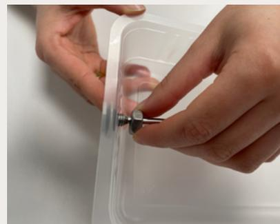
3. En el interior del envase de la muestra, roscar la tuerca sobre el termopozo.
