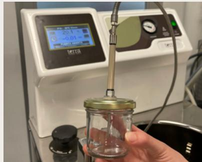
5. Colocar una junta tórica luego del separador plástico y por último **roscar el envase de la muestra a la sonda corazón\*** de temperatura de la autoclave.
