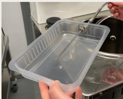
5. Por último, en el extremo del termopozo\* **roscar el envase de la muestra a la sonda corazón** de la autoclave.
